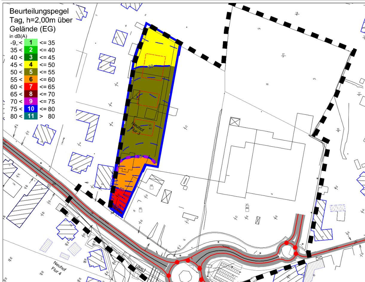
Abbildung 3: Beurteilungspegel (Tag), h = 2 m über Gelände
